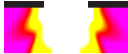
Querschnitt der Intensitätsverteilung von i-line (365 nm) Licht in einer 1 µm dicken Lackschicht unter einer 1 µm Öffnung
